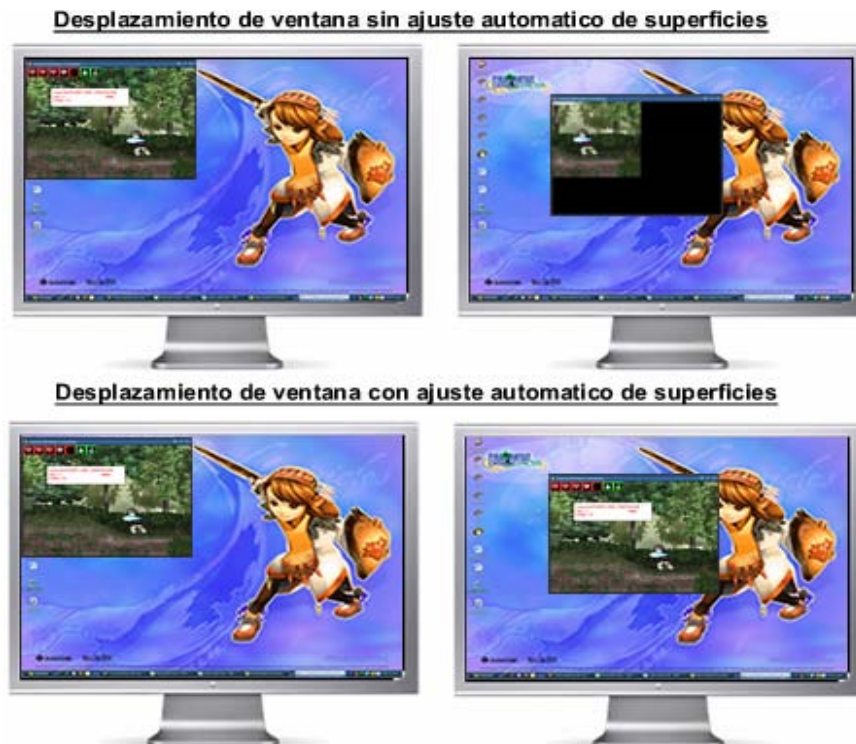
Figura 62. Desplazamiento automático de superficies en modo ventana
