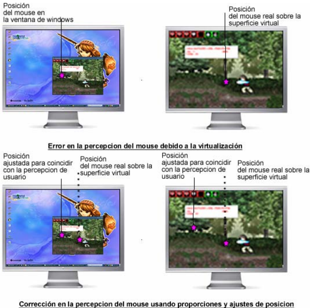
Figura 104. Corrección de la percepción errada del mouse por virtualización
